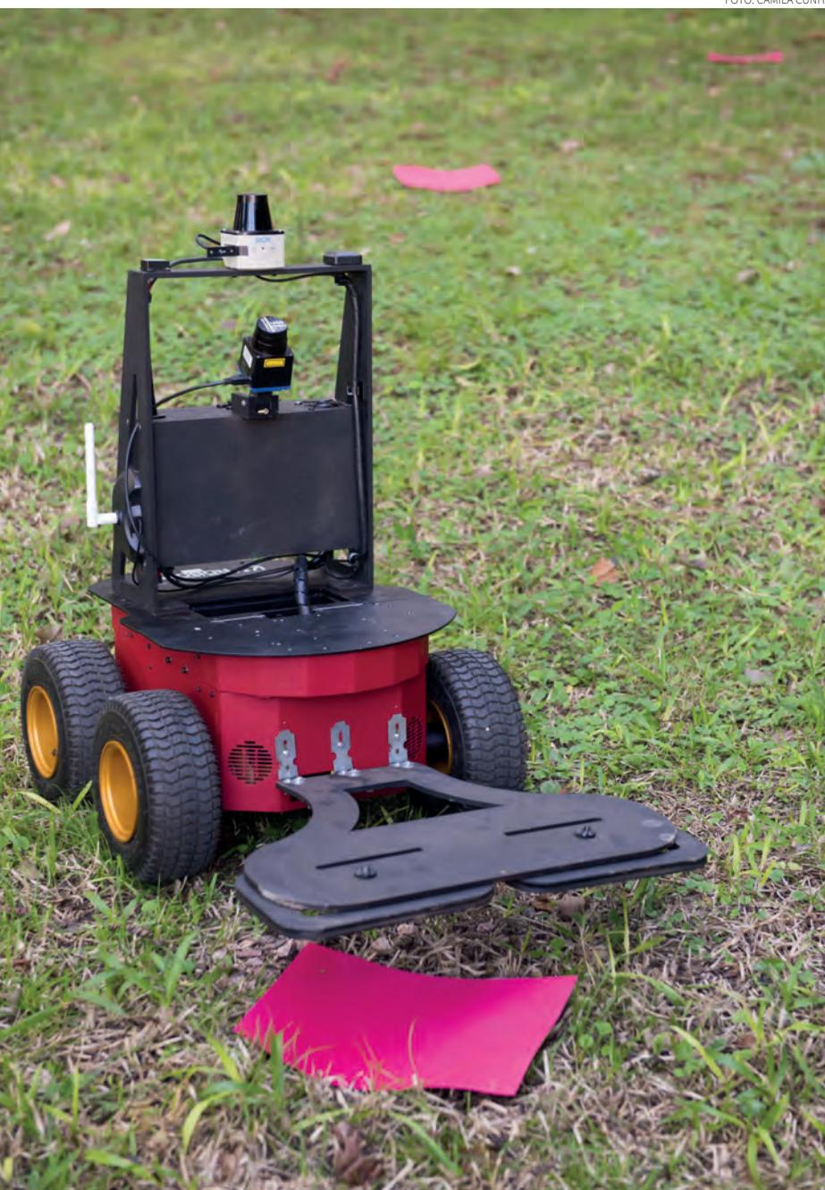
*Robô com detector de metais foi construído por alunos da Universidade*
