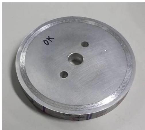
Figura 5.30. Corpo de prova da Liga 782 após o ensaio de desgaste.
