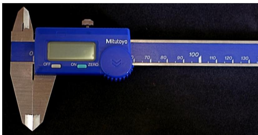
Figura 24. Paquímetro digital.
