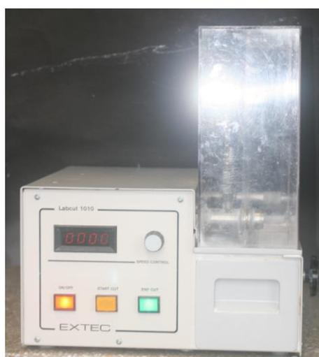
Figura 21. Máquina de corte Labcut 1010.
