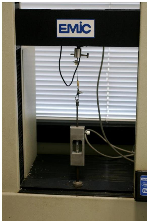
Figura 26. Montagem do dispositivo na máquina universal de ensaio.
