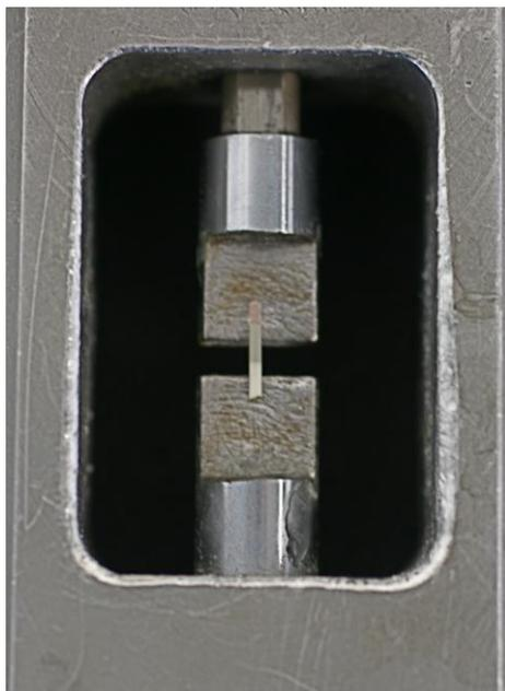
Figura 25. Área adesiva posicionada perpendicularmente ao longo eixo.
