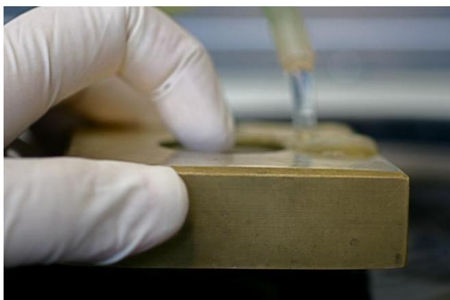
Figura 4. Suporte metálico sendo utilizado para desgaste das amostras na politriz sob-refrigeração de água.
