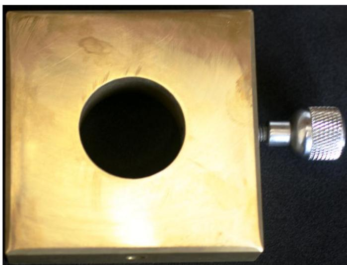
Figura 2 . Suporte metálico para padronização do desgaste das amostras.
