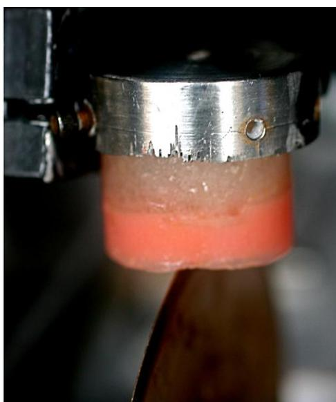
Figura 22. Cortes seriados perpendiculares à interface adesiva.
