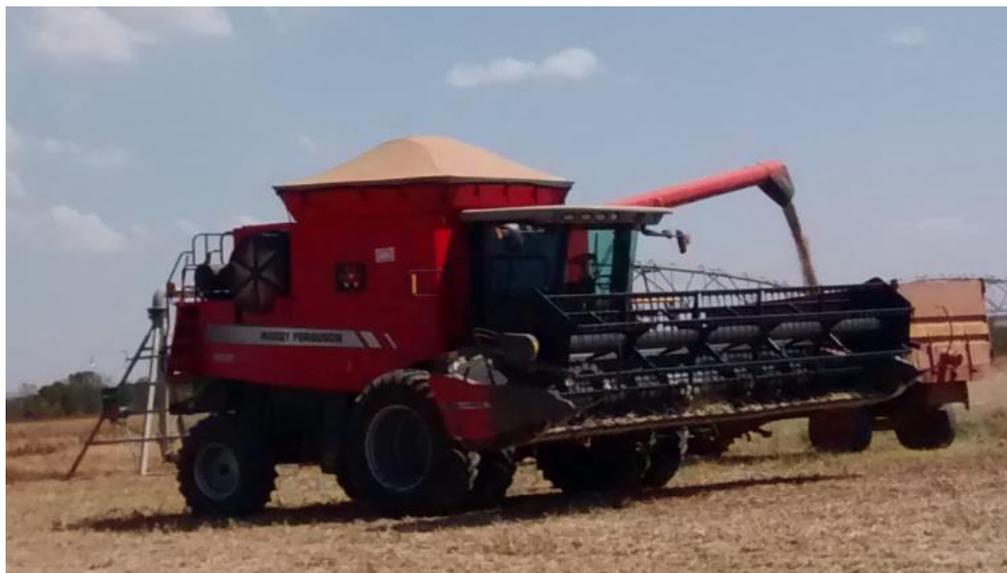
Figura 5.36. Colheitadeira axial utilizada no comparativo modelo MF9690 ano de fabricação 2011.
