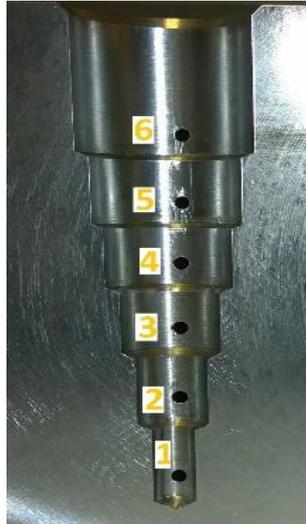
Figura 4.9 - Disposição dos termopares no molde.
