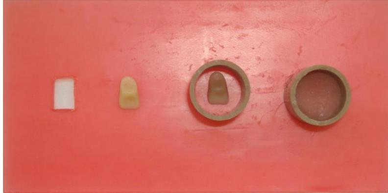
**Figura 3 – Método de inclusão dos dentes para realização do teste. Abertura na cera nº7, sobre uma placa de vidro; anéis de PVC posicionados sobre a lâmina de cera nº7, envolvendo cada um dos dentes de acrílico, sendo preenchidos com resina acrílica autopolimerizável.**
