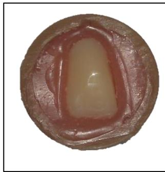
**Figura 4 – Dente de acrílico incluído no anel de PVC.**
