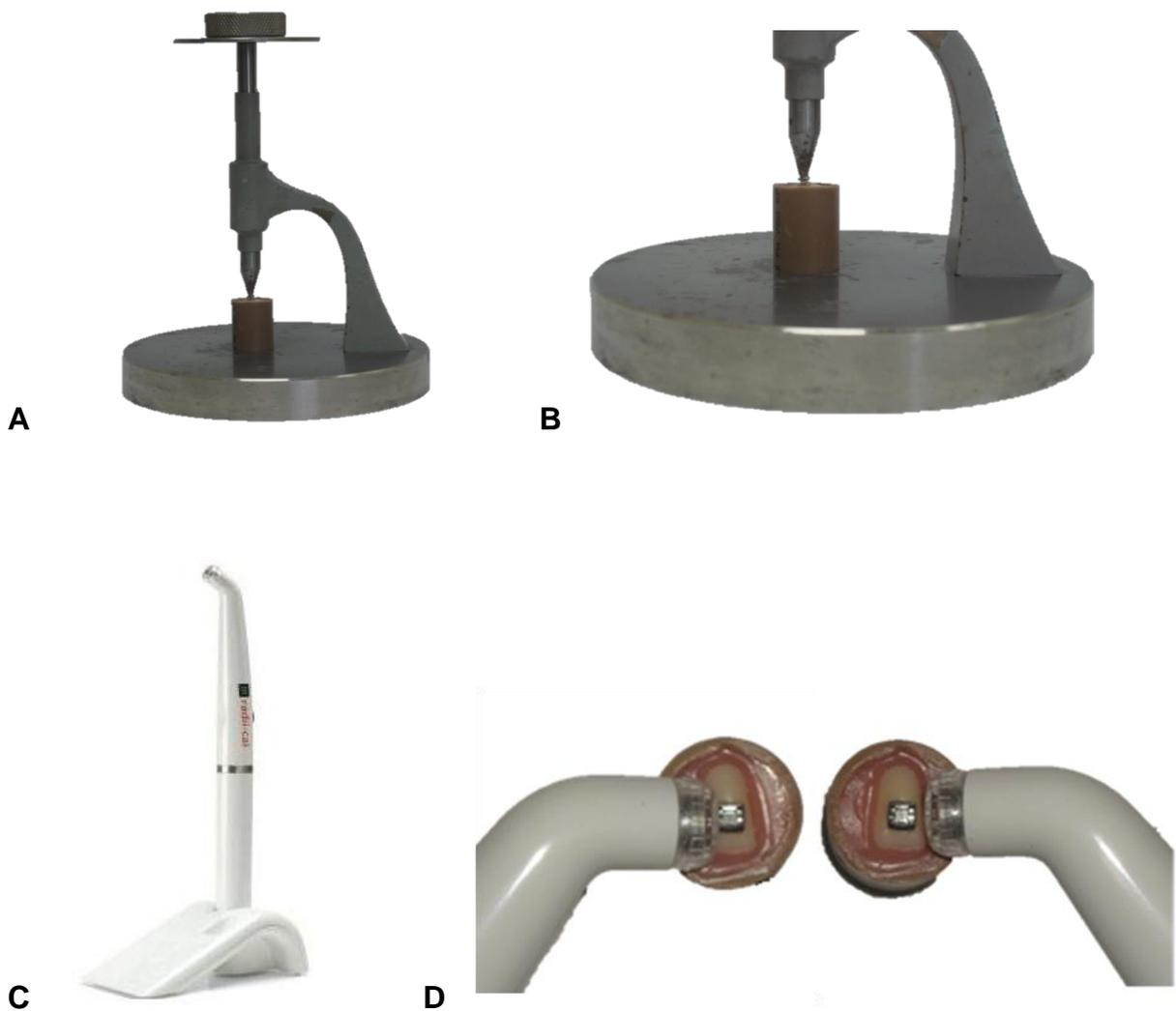
**Figura 7 – Em A e B, dispositivo para padronizar espessura do adesivo utilizado para a colagem do bráquete. Em C, aparelho de fotopolimerização por *Light Emitting Diode* (LED). Em D, posicionamento da fibra óptica do LED para a fotopolimerização.**
