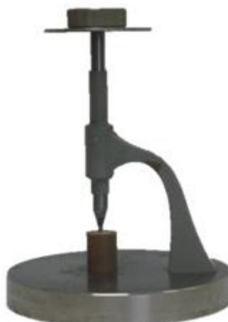
Figura 1 – Dispositivo customizado para padronizar espessura do adesivo entre a base do bráquete e a superfície do dente.
