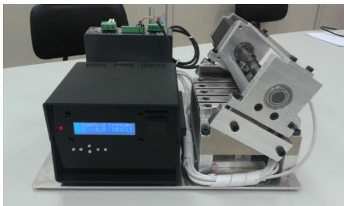
**Figura 5** - Vista lateral da célula aferidora de pré-carga e driver do motor
