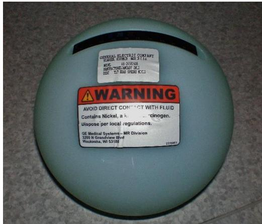
Figura 1. Objeto de teste esférico GE MRI ACR Phantom modelo 46-265826G6.
