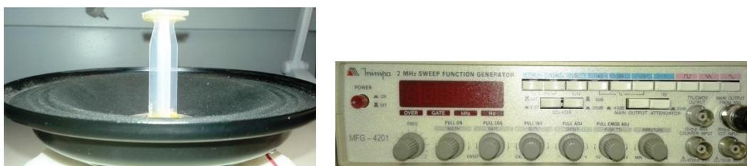
Figura 5.1: Fotografias dos equipamentos do sistema VMCV. Em (a) o alto-falante com um suporte de plástico para posicionamento do substrato, e (b) o gerador de áudio.
