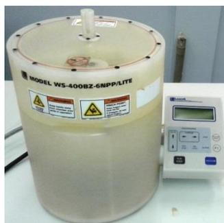
Figura 4.7. Fotografia do *Spin Coater* utilizado na preparação das amostras de TCTF de AgNWs.
