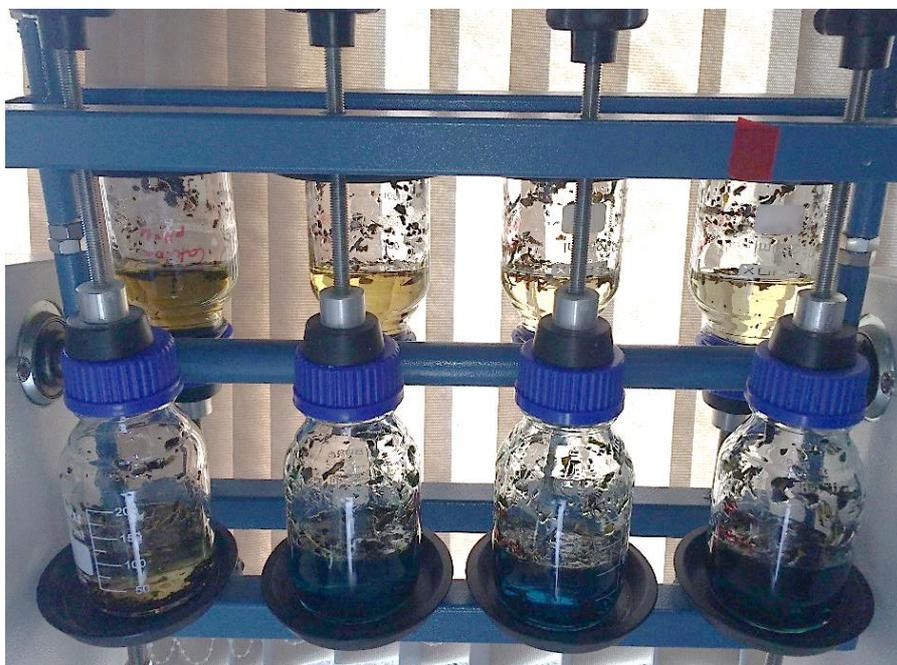
Figura 4.15. Agitador de Wagner e frascos Schott utilizados neste estudo.
