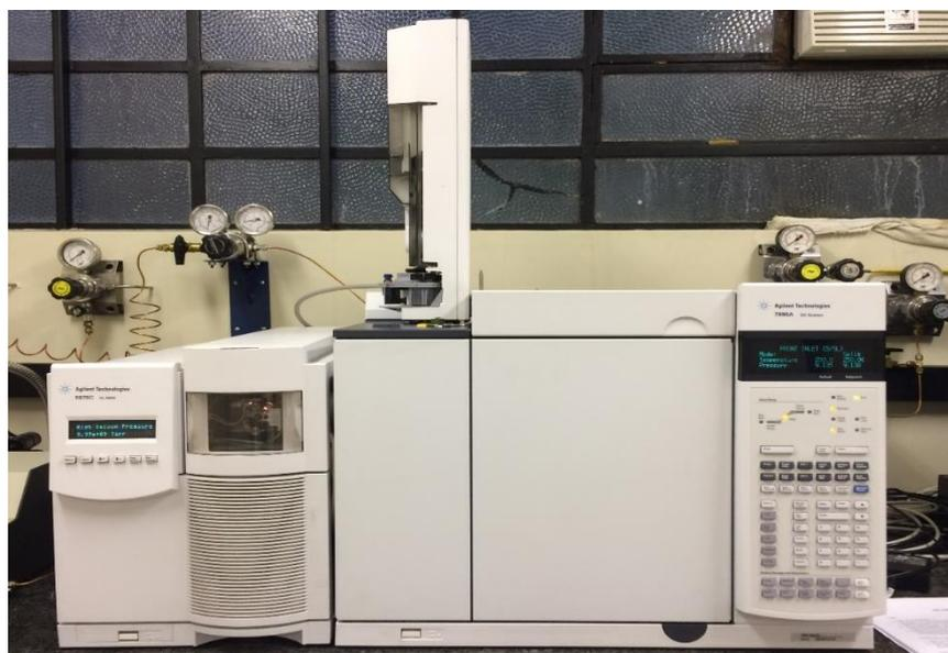
Figura 4.7. Cromatógrafo a gás com espectrômetro de massas.
