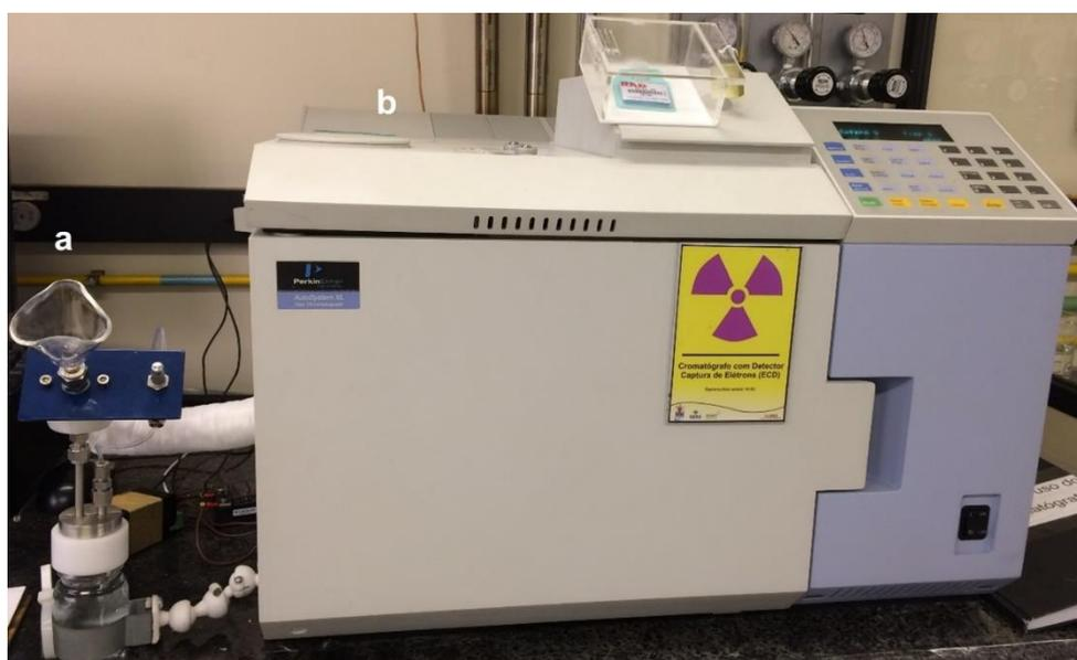
Figura 4.9. (a) Detector olfatométrico; (b) Cromatógrafo a gás com sistema de detecção por ionização de chama (FID).
