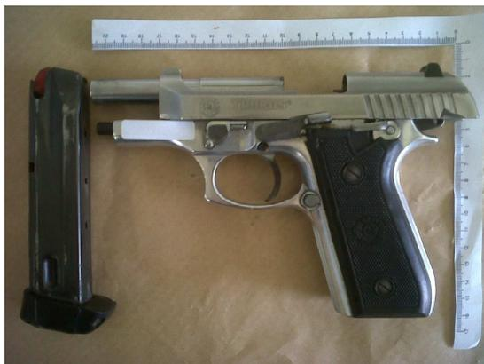
**Figura 3.** Pistola semi-automática 0.380, Modelo PT 58S, Marca Taurus. Fonte: cedida pela Perita Joseli Baldasso do IGP/RS, 2009.
