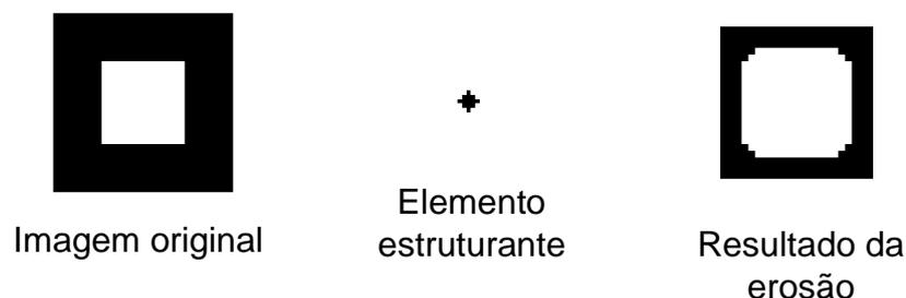
Figura 24: Exemplo de aplicação da operação de erosão.
