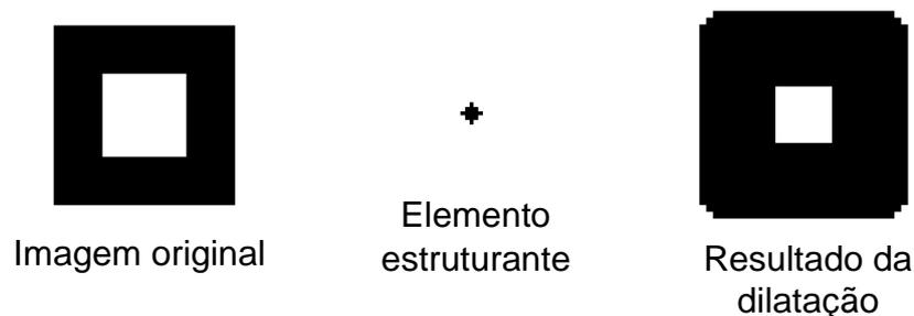
Figura 23: Exemplo de aplicação da operação morfológica de dilatação.
