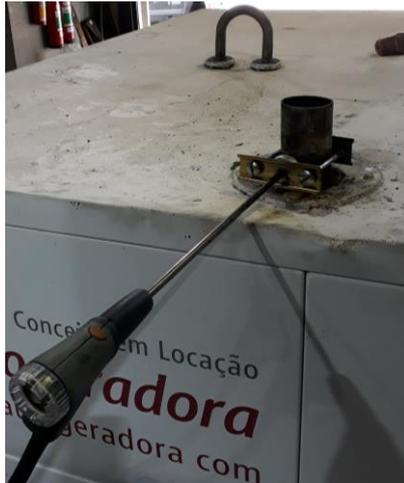
Figura 4.7. Posicionamento da sonda de medição dos gases de exaustão.
