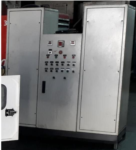
Figura 4.2. Banco de cargas resistivas para simular a demanda energética.
