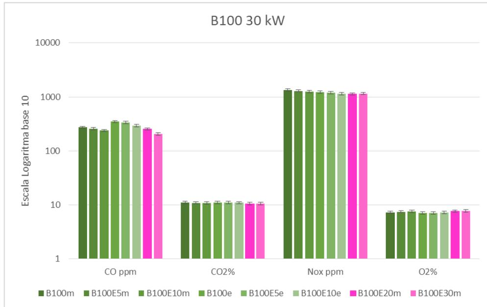
Figura 5.13. Emissões médias dos gases de exaustão para o B100, carga 30 kW.
