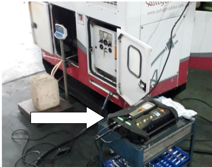
Figura 4.8. Central de controle do analisador de gases.
