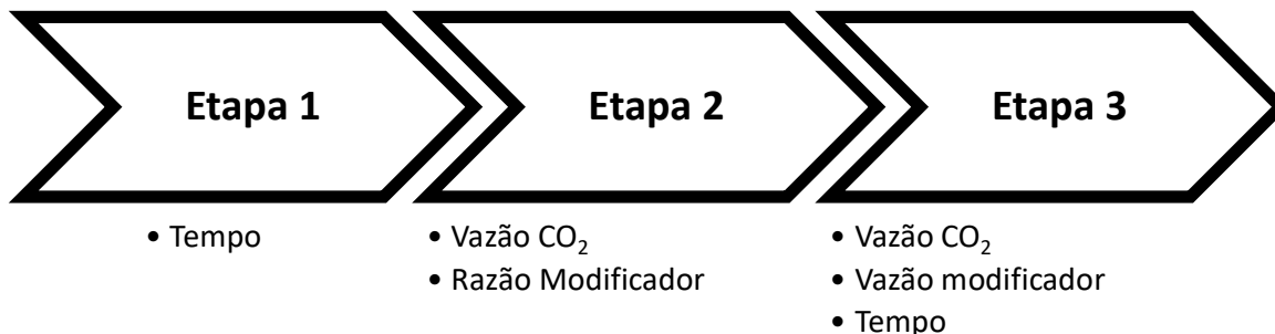
Figura 4.10 - Etapas de extração supercrítica para remoção de cafeína da erva-mate
