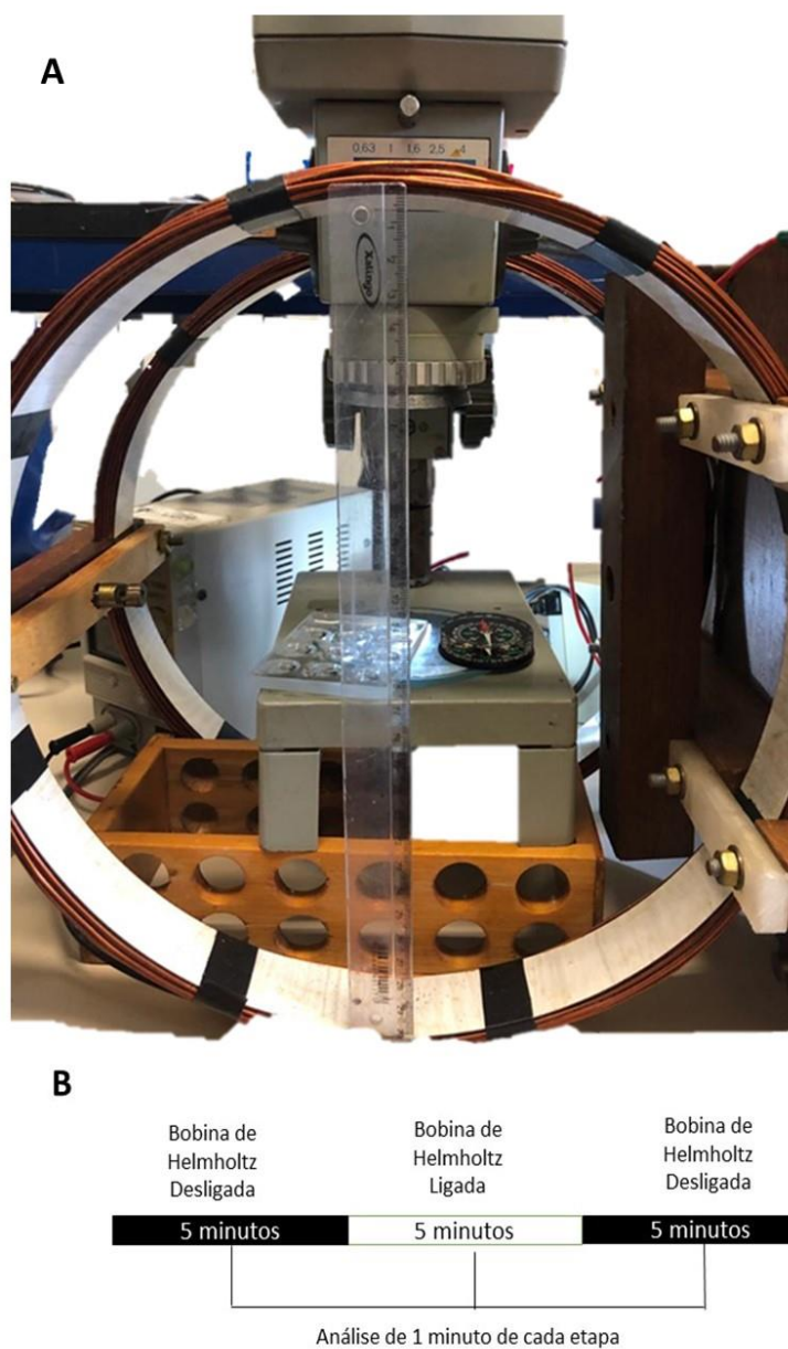
Figura 6. A Foto da bobina de Helmholtz, conectada à fonte, e com adaptação de uma lupa estereoscópica, sendo posicionado na mesa da lupa a placa de poços côncavos, e ao lado uma bússola. B. Tempo de filmagem de acordo com a exposição ao campo magnético, sendo avaliado um minuto de cada filmagem pelo programa ImageJ.
