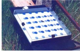
Figura 1. Primeiro protótipo do módulo concentrador estático plano (MEC-P).
