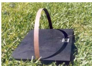
Figura 14. Dispositivo utilizado para medir a irradiância difusa.
