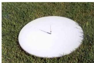
Figura 13. Dispositivo utilizado para medir o ângulo de incidência da radiação solar.
