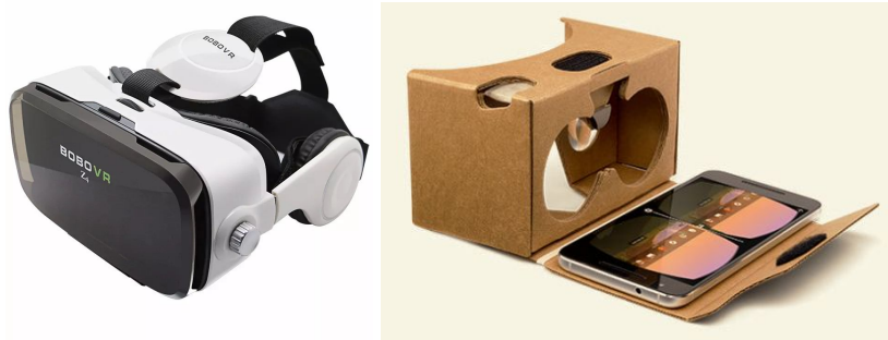
Figura 02 - Da esquerda para a direita: óculos de realidade virtual genéricos que permitem o acoplamento de um smartphone e a segunda geração do Google Cardboard, com a tampa da frente aberta revelando o smartphone ajustado para a exibição binocular. Fontes: https://goo.gl/g4C9AB e https://vr.google.com/cardboard/ - Acesso em: 13 jun 2017.
