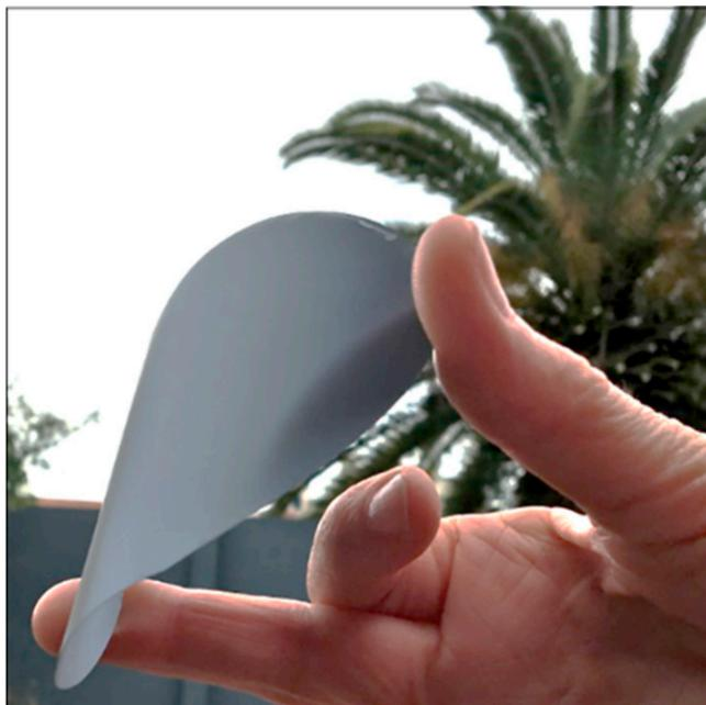
Figura 10: Imagem de lâmina de silício com 100  $\mu\text{m}$  de espessura utilizada na fabricação de células solares n-PERT no Brasil.
