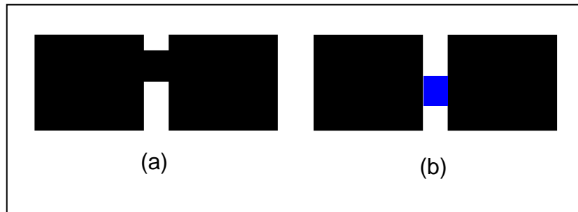
Figura 33: (a) vista frontal da associação de capacitores de placas paralelas em paralelo. (b) vista de trás da associação. Note que a ligação entre as placas desta face não está no mesmo nível da primeira.
