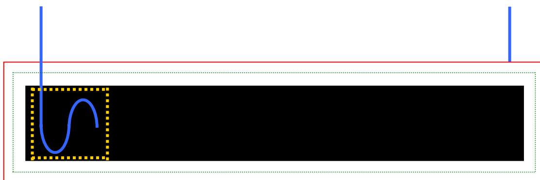
Figura 38: capacitor plano de placas paralelas. O retângulo pontilhado na cor ouro é a fita adesiva para prender o eletrodo; atrás surge o outro eletrodo que deve ser moldado e preso da mesma forma.
