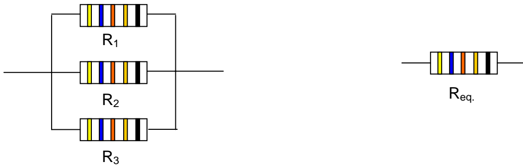
Figura 6: três resistores associados em paralelo e resistência equivalente da associação.
