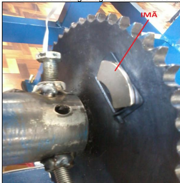
Figura 32 - Imã anexado na engrenagem do sistema de tração central
