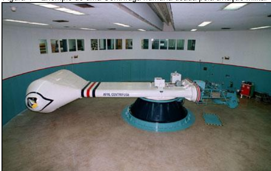
Figura 4 – Exemplo de uma Centrífuga humana usada pela aviação militar
