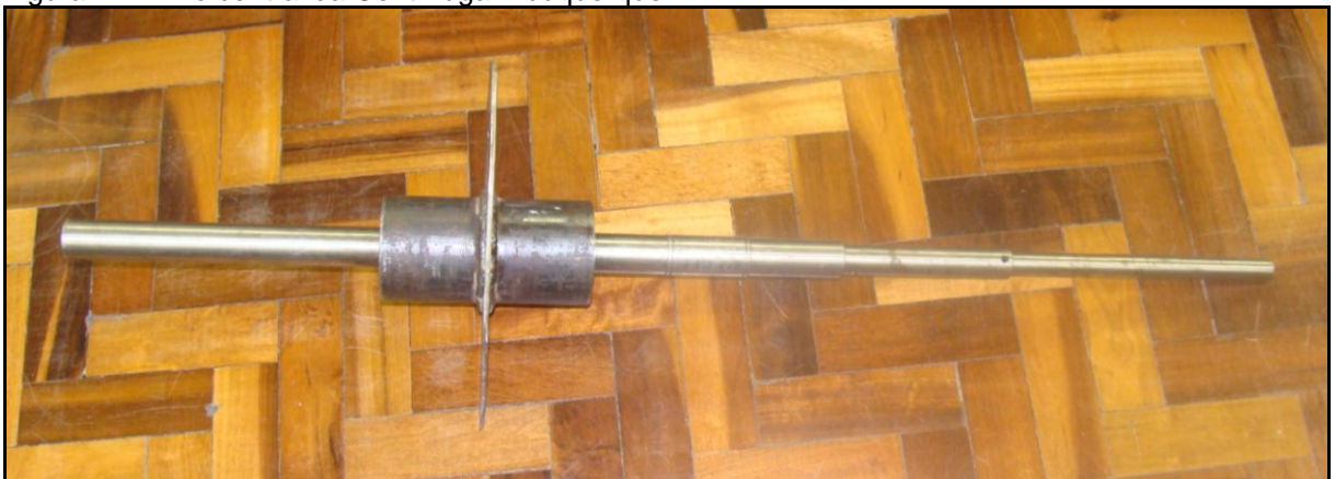
Figura 14 - Eixo central da Centrífuga Albuquerque
