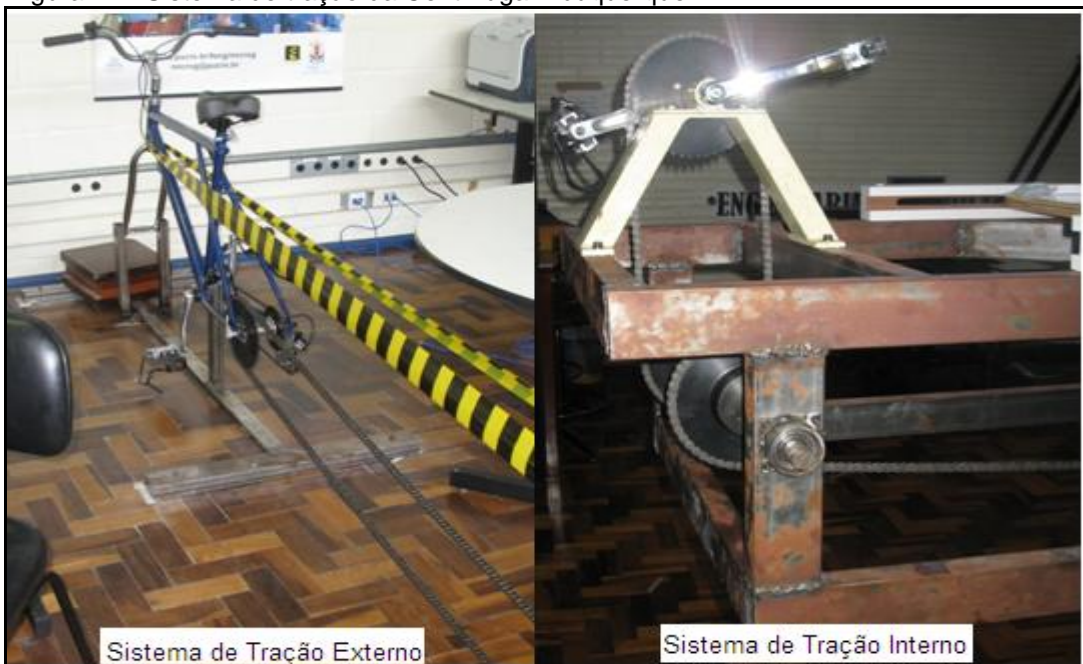
Figura 17 - Sistema de tração da Centrífuga Albuquerque
