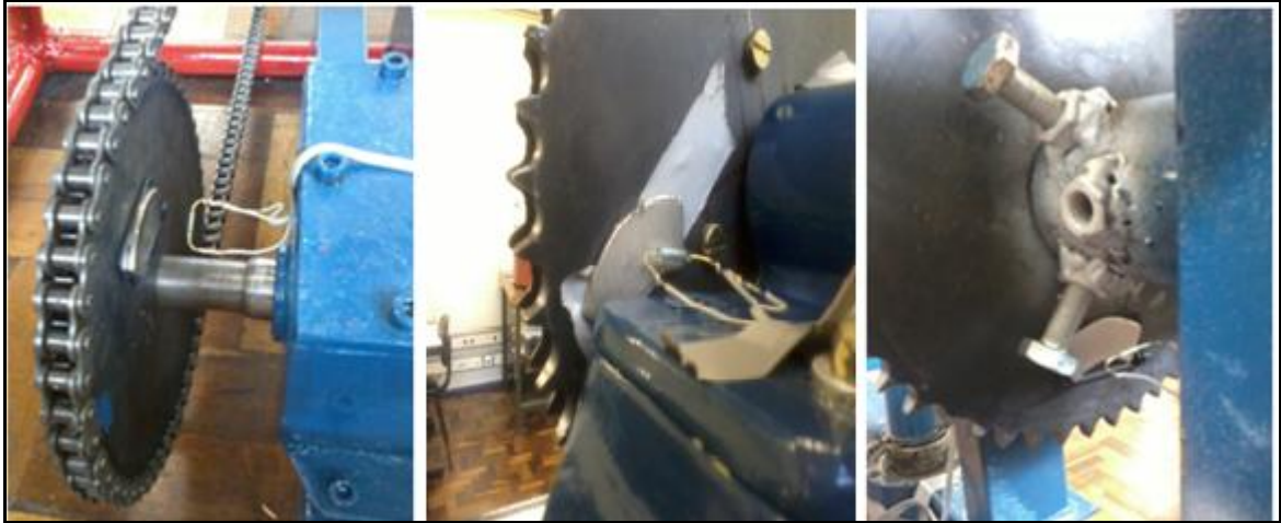
Figura 35 - Sistema de aquisição de rpm da Centrífuga
