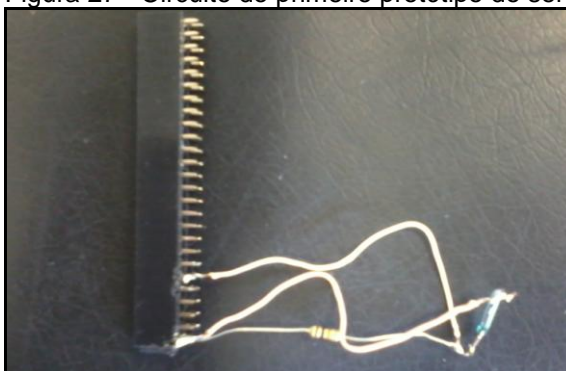
Figura 27 - Circuito do primeiro protótipo do sensor magnético
