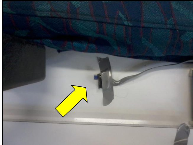
Figura 41 - Acelerômetro localizado na região do coração do voluntário
