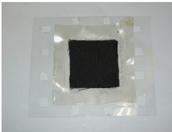
FIGURA 4.9: MEA colocado sobre uma única folha de Mylar para montagem da célula.
