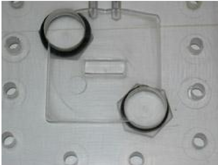
FIGURA 3.2: Placa do ânodo com reservatório para metanol.
