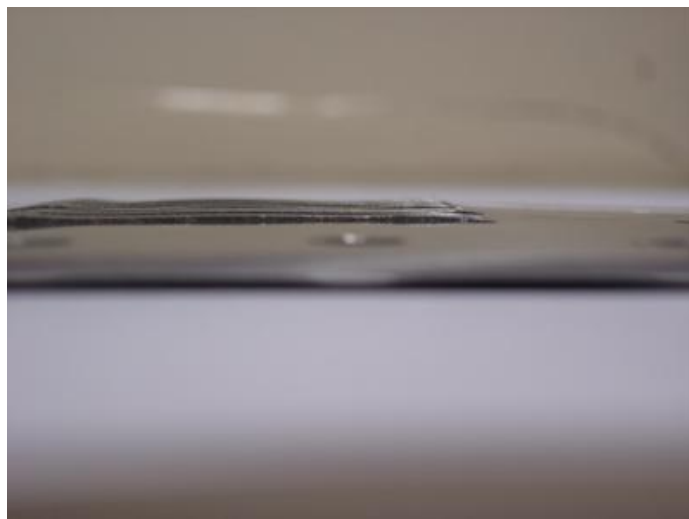
FIGURA 4.10: Vista perpendicular do eletrodo de aço, mostrando a elevação da grade.
