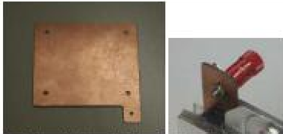
Fig. 2. A segunda placa condutora de cobre e à direita detalhes do conector do pólo positivo.
