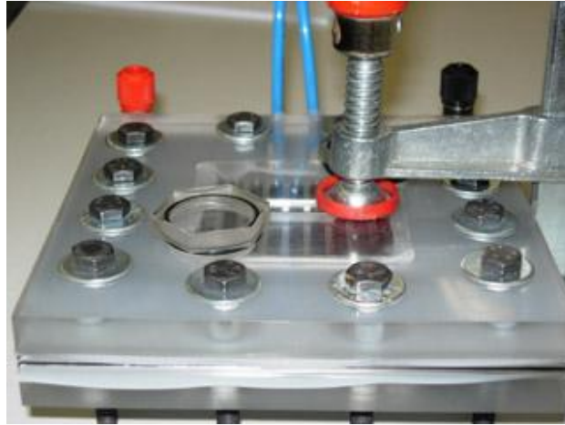
FIGURA 4.11: Compressão externa no centro da célula.
