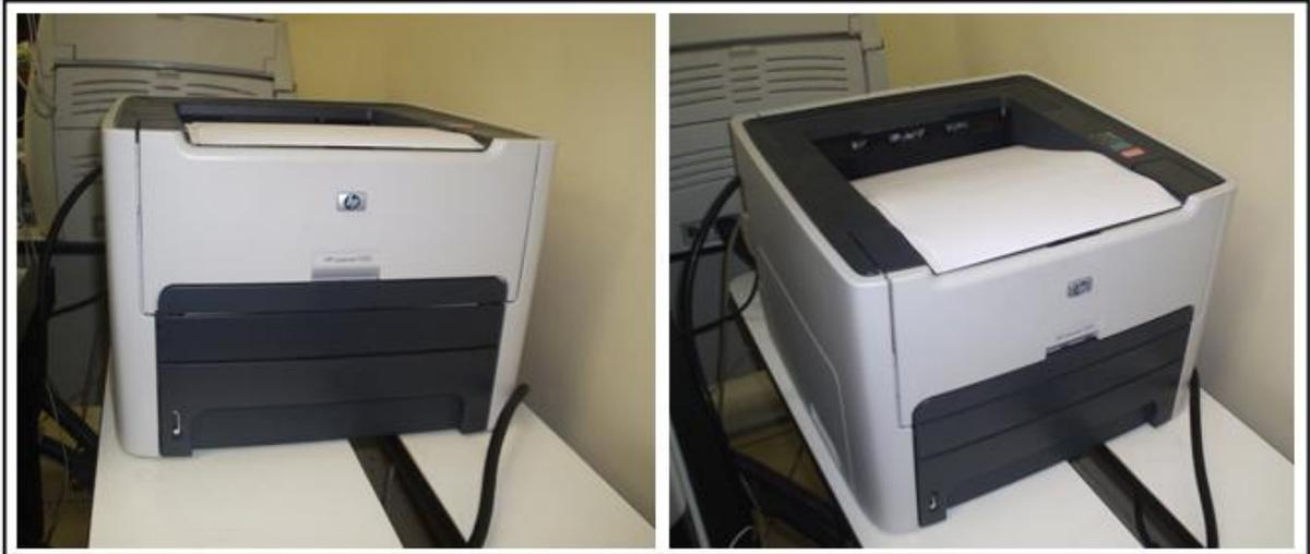
Figura 7.30 Experimento com uma carga não linear: impressora HP1320.
