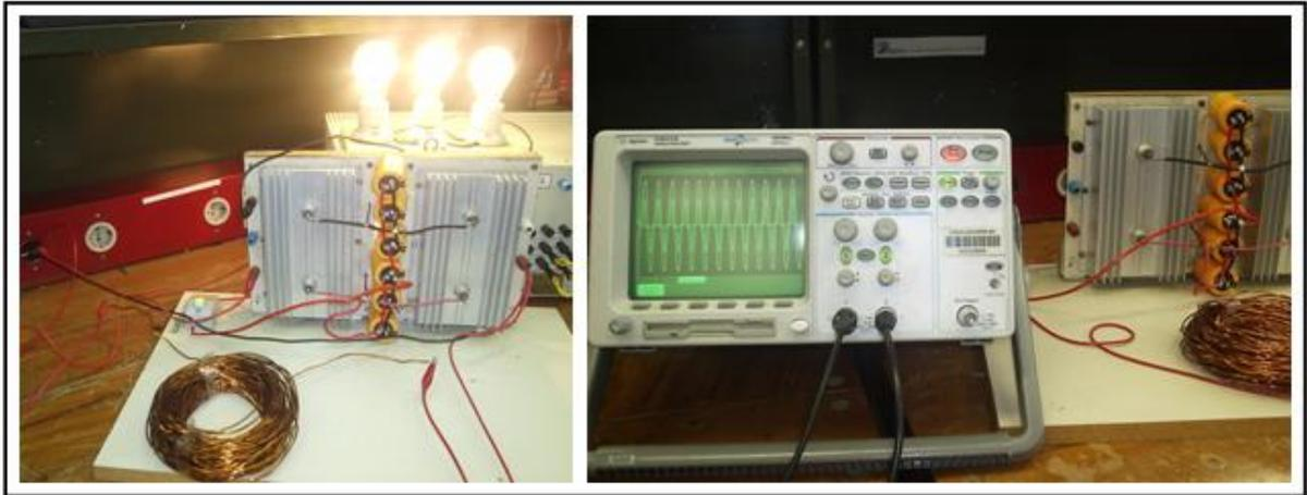
Figura 7.7 Experimento: retificador em ponte com carga  $RC$  e indutor  $L$  de entrada.
