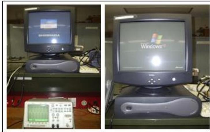
Figura 7.18 Experimento com uma carga não linear: computador Dell
