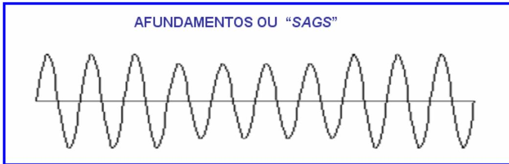
Figura 2.5 Fenômeno de perturbação da rede: afundamentos ou “sags”.
