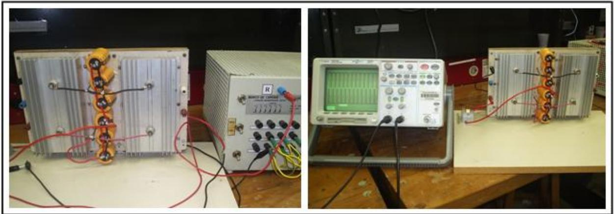
Figura 7.3 Experimento com o retificador monofásico em ponte completa com carga  $RC$ .
