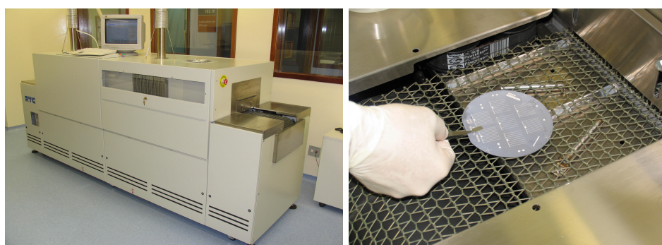
Figura 26. (a) Forno de secagem e recozimento de pastas do NT-Solar, marca RTC, modelo LA-309 e (b) lâmina metalizada sendo introduzida no forno.Otimização do recozimento das pastas.
