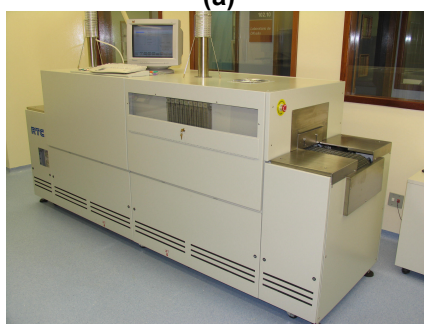
Figura 7. (a) Esquema e (b) foto do forno de recozimento de pastas serigráficas do NT-Solar (Núcleo Tecnológico de Energia Solar).
