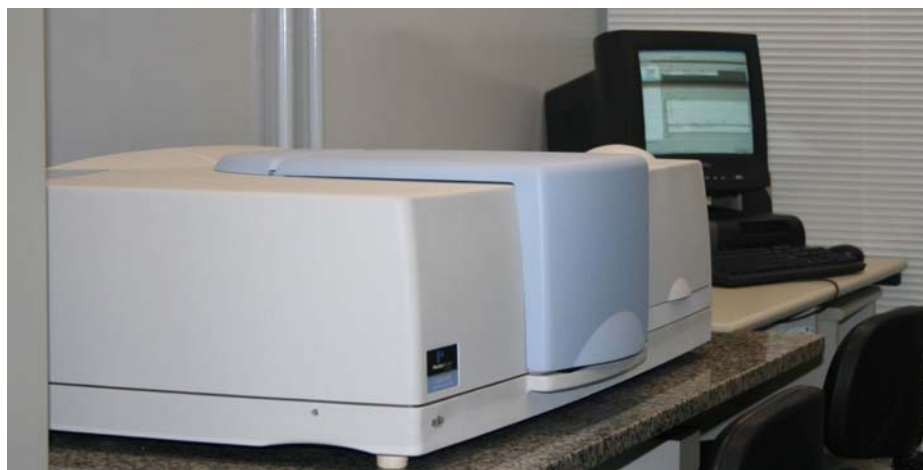
Figura 3.2 Espectrofotômetro Lambda 950 Perkin-Elmer, utilizado por medição da refletância.
