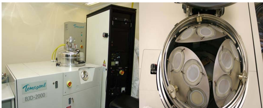
Figura 3.1. Sistema de evaporação utilizado para deposição dos filmes AR.
