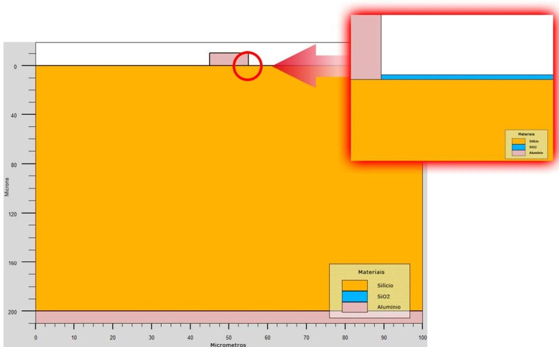
Figura 2.13. Exemplo de estrutura básica de célula solar simulada no ATHENA.
