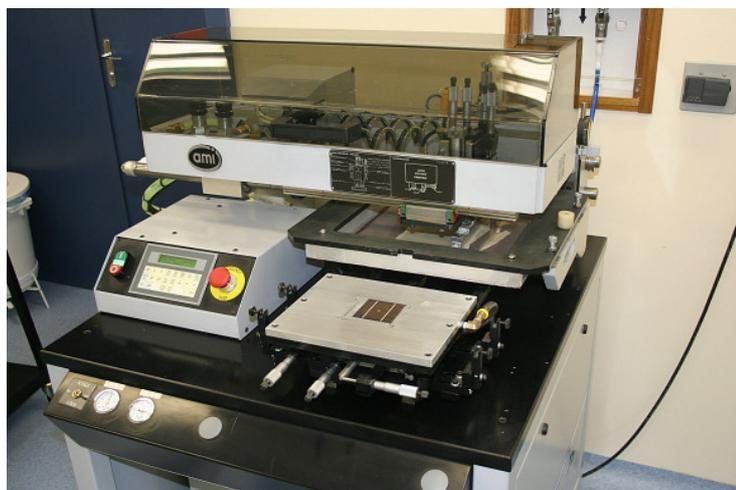
Figura 4.6. *Screen-printer*, equipamento utilizado para deposição da malha metálica por serigrafia.
