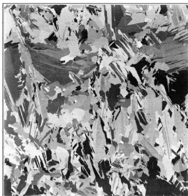
Figura 3.2. Lâmina de Si-mc mostrando a complexidade e não-homogeneidade do material [32].
