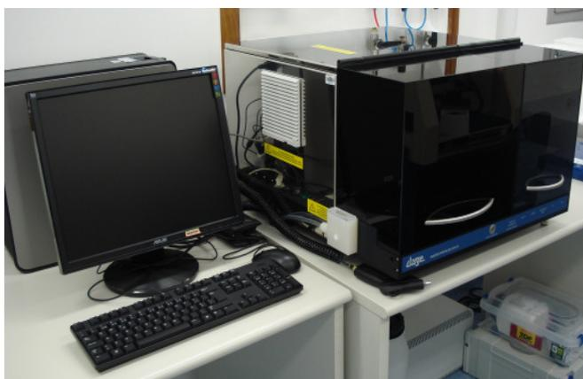
Figura 4.10. Wafer Profiler CVP21, equipamento utilizado para medição dos perfis de dopagem do fósforo.
