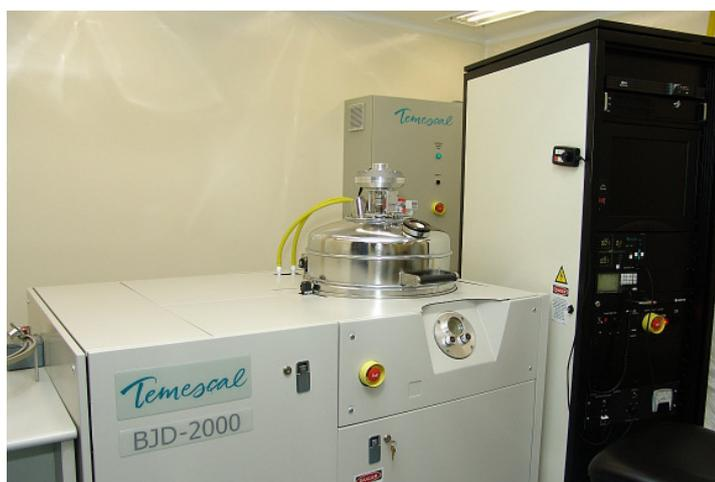
Figura 4.5. Evaporadora utilizada para a deposição de Al e filme AR.
