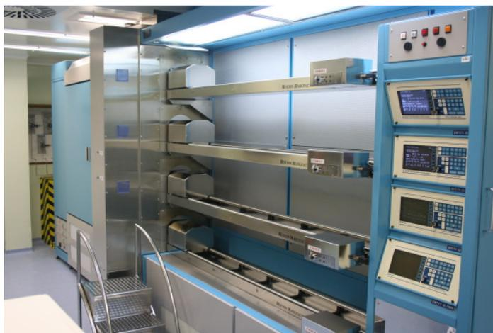
Figura 4.4. Forno convencional com tubo de quartzo utilizado para a difusão dos dopantes.
