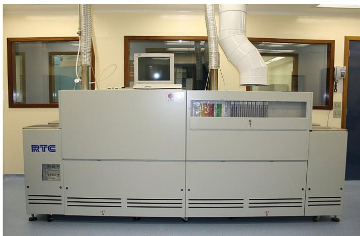
Figura 4.8. Forno de esteira, da marca RTC, utilizado para secagem e queima da pasta metálica.
