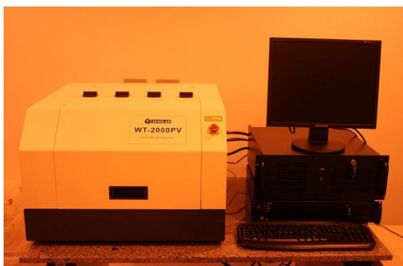
Figura 4.12. Equipamento WT-2000PV, utilizado para a obtenção da distribuição bidimensional do comprimento de difusão dos portadores minoritários, da eficiência quântica e da refletância.
