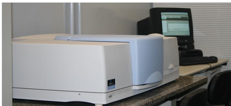
Figura 4.11. Espectrofotômetro Lambda 950, utilizado para medidas de refletância.
