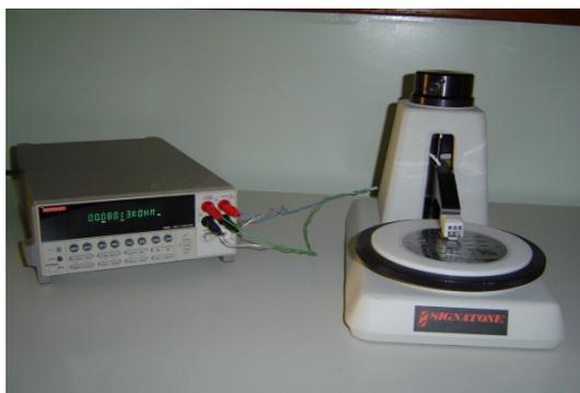
Figura 4.9. Equipamento "4 pontas", utilizado para medição da resistência de folha.
