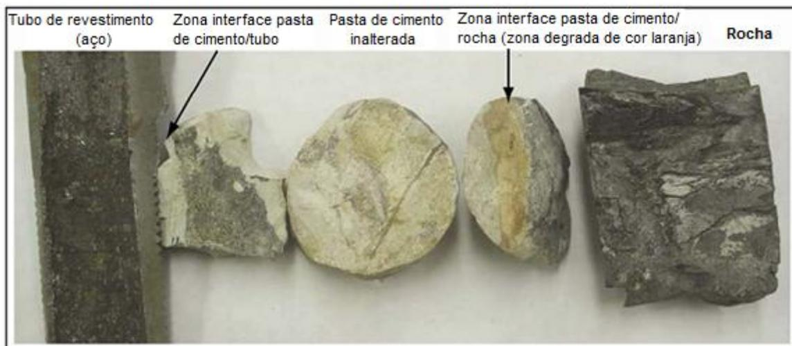
Figura 3.32: Testemunhos de aço, pasta de cimento e rocha do campo SACROC, Texas, EUA (DALLA VECCHIA, 2009 adaptado Carey *et al.*, 2007).
