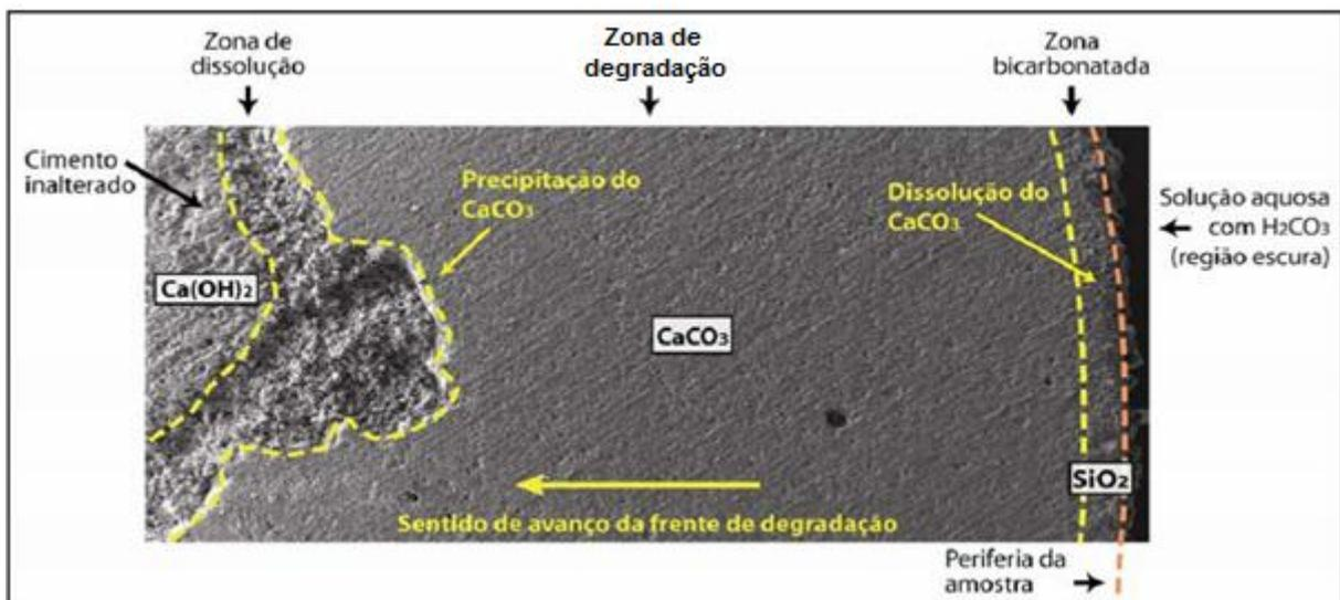
Figura 3.29: Imagem de MEV representando o esquema da alteração da pasta de cimento devido às reações em meio  $\text{CO}_2$  supercrítico e sua dinâmica de reações (DALLA VECCHIA, 2009).
