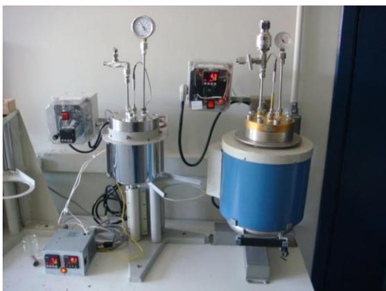
Figura 4.7: Reatores para ensaio de carbonatação acelerada em meio ácido.
