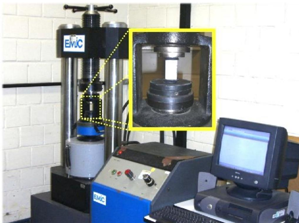
Figura 4.11: Prensa hidráulica para realização do ensaio de compressão (DALLA VECCHIA, 2008).
