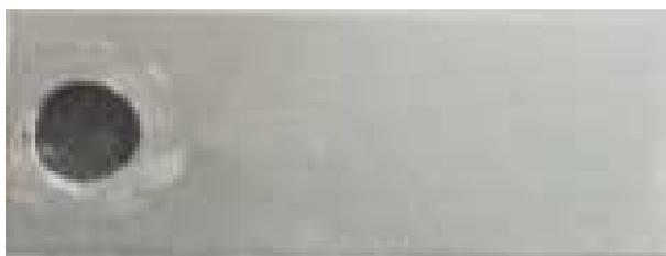
Figura 4.1. – Corpo de prova de Ti (grau 1).
