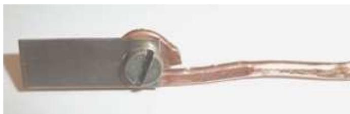
Figura 4.3. – Configuração do eletrodo acoplado a haste de cobre.
