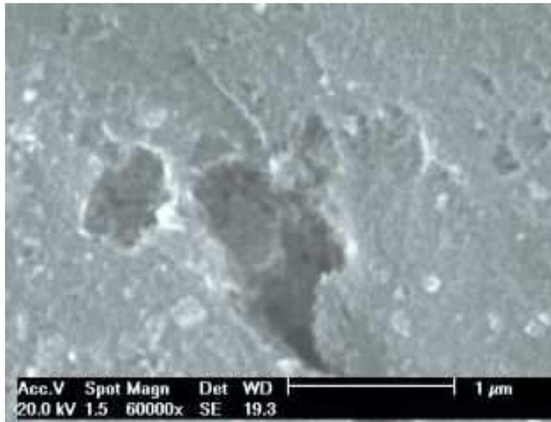
Figura 5.14. – Micrografias dos corpos de prova anodizados com tensão de 20V e distância entre eletrodos de 30mm.
