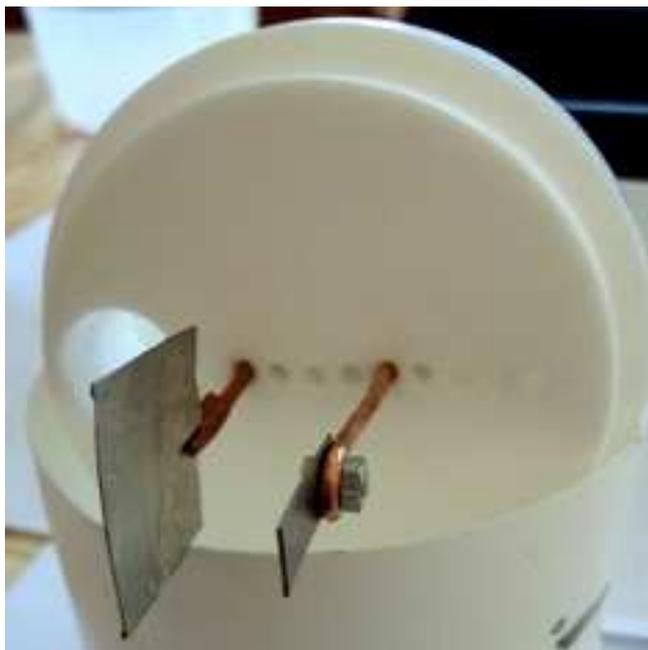
Figura 4.2. – Configuração da célula eletrolítica.
