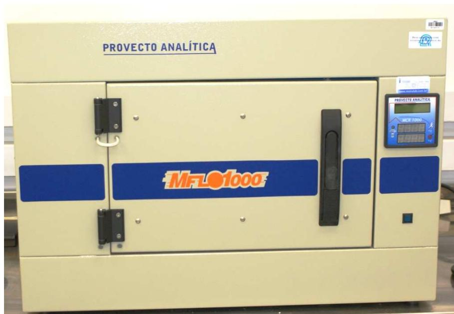
Figura 4.5. – Equipamento forno mufla por microondas utilizado no T.T. .
