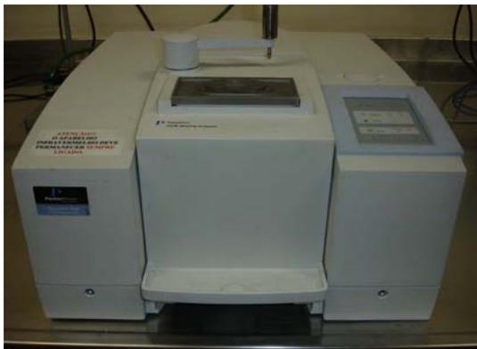
Figura 13 – Espectrômetro de Infravermelho.
