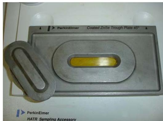
Figura 14- Placa de Cristal de Selenito de Zinco.
