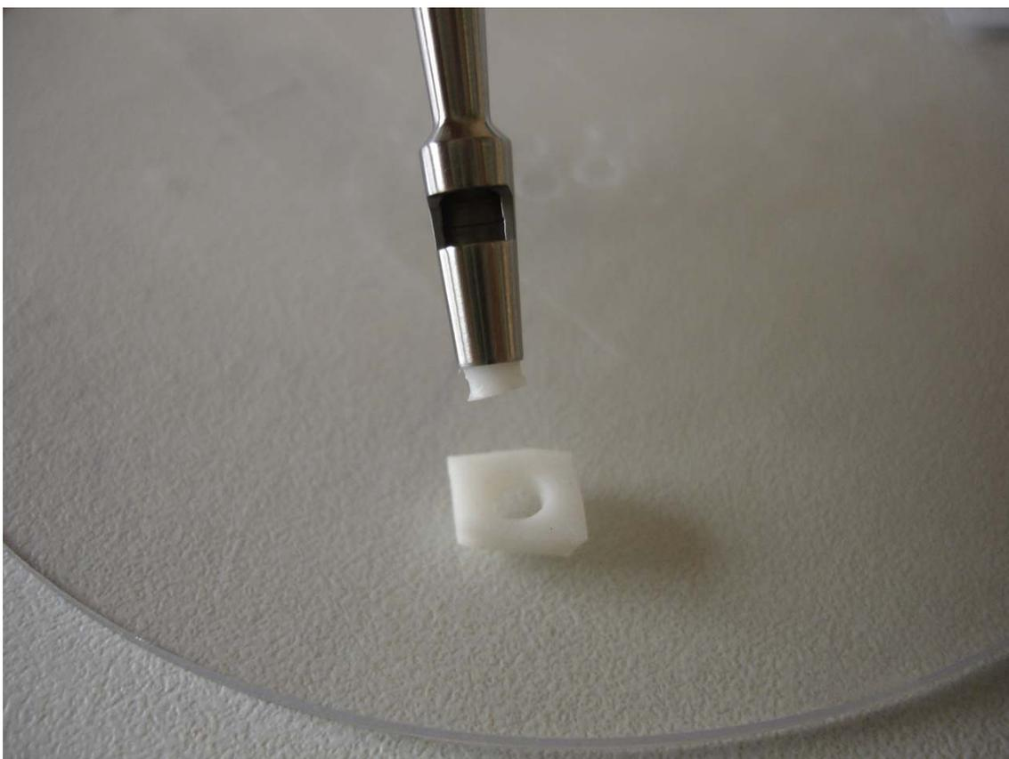
Figura 10 – Corpo-de-prova padronizado pelo diâmetro do punch de 4 mm.
