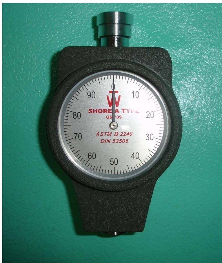
Figura 11 – Durômetro portátil analógico Teclok Shore A.
