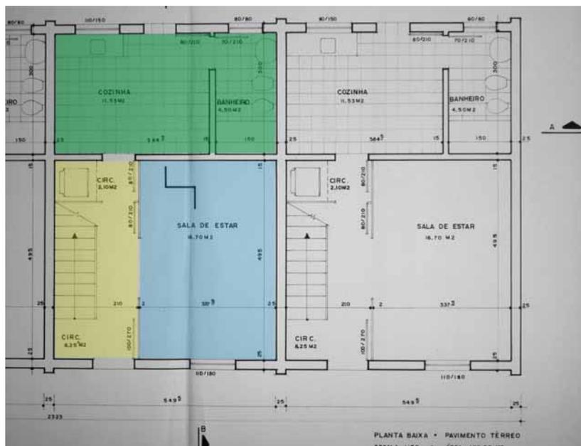
Figuras 149: Esquema de setorização na planta baixa do pavimento térreo das casas de quarta ordem. Nesta Figura, aparecem apenas duas moradias das quatro que fazem parte do conjunto. Fonte: Levantamento do Conjunto Residencial Cia. São Pedro. Responsável Técnico: Eng. Civil Juarez Settin (imagem editada pela autora). Galópolis, 1980. Acervo: Arquivo Cia. Sehbe S.A.
