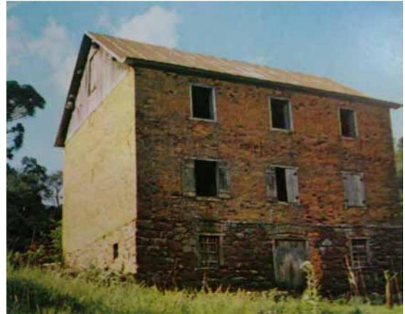
Figura 49: Casa na Linha Júlio de Castilhos em Veranópolis, utilizando três materiais na forma mista: pedra, tijolos e madeira.
