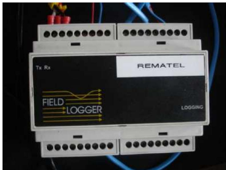
Figura 10 - Cabos de compensação unidos à placa de aquisição de dados do tipo field logger
