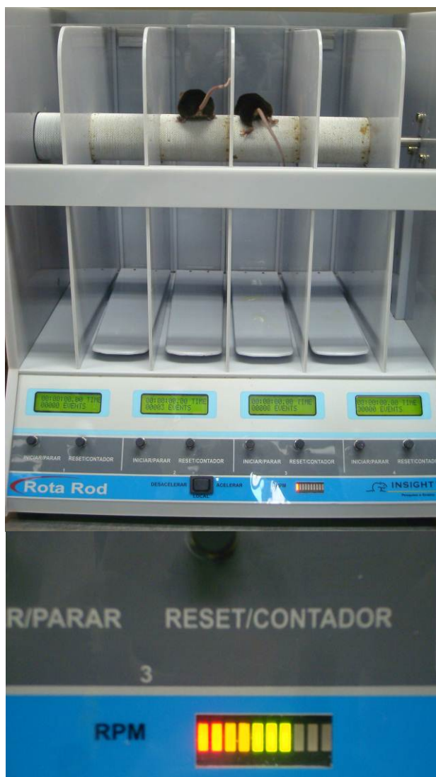
Figura 4 – Teste de Rotarod. Animais são colocados no cilindro em movimento e a latência, velocidade/fase de queda do animal é avaliada.
