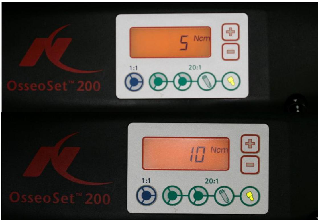
Figura 4: Aplicação do torque progressivo utilizando motor protético
