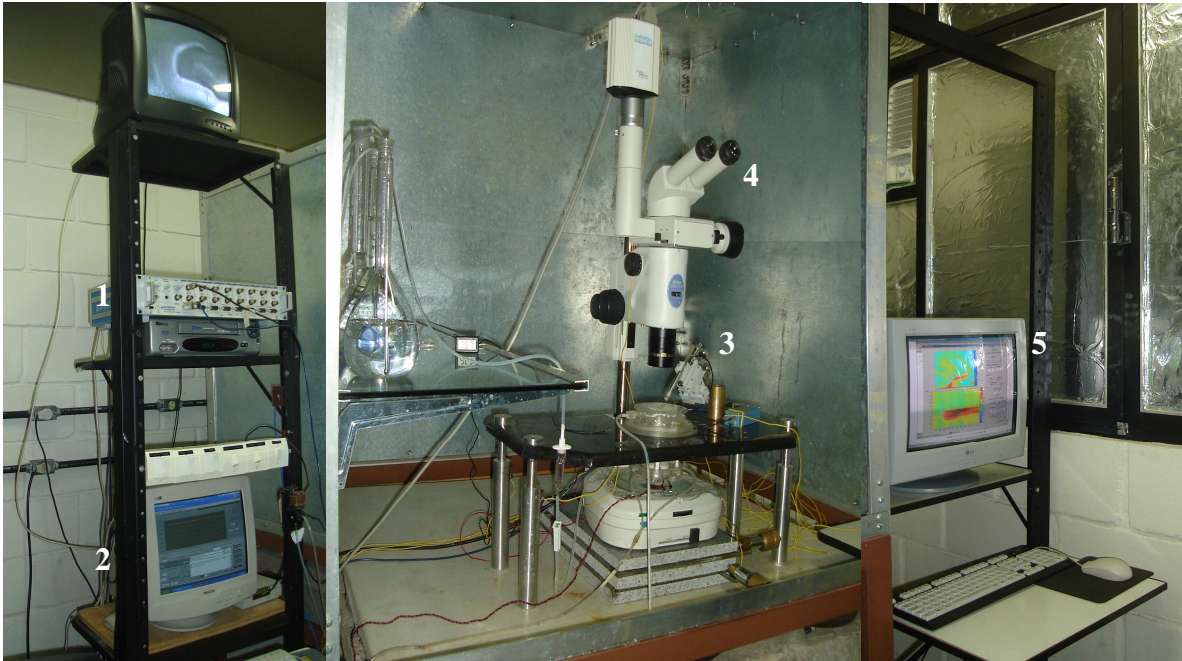
Figura 14 – Equipamentos utilizados para obtenção do registro simultâneo do PE e do IOS durante as AE em fatias do hipocampo. 1- Amplificador CYBERAMP 380 para amplificação do sinal elétrico; 2- “Setup” para registro do potencial elétrico extracelular; 3- Pré-amplificador (Headstage modelo AI 402 x 50) para aquisição dos sinais e foi interligada a um amplificador biológico; 4- Microscópio estereoscópico (modelo NIKON – SMZ 1500) para visualização das fatias e obtenção do IOS; 5- Imagem do sinal óptico intrínseco obtida na tela do microcomputador através do programa Matlab 6.5 (Imagem VET_online).
