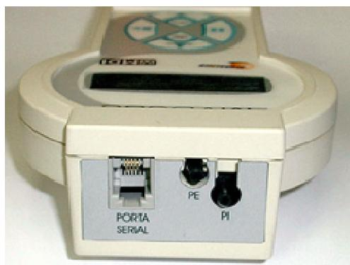
**Figura 5 -** Manovacômetro Digital MVD 300® da Globalmed.
