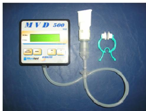
**Figura 6 -** Manovacômetro Digital MVD 500® da Globalmed.
