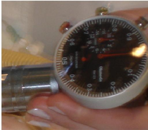
**Figura 2–** Ventilômetro analógico Chamedá<sup>®</sup>.
