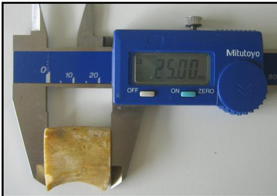
**Figura 5: Aferição do comprimento da amostra (25mm).**
