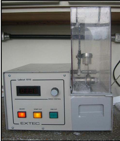
**Figura 11: Máquina da corte Labcut 1010.**
