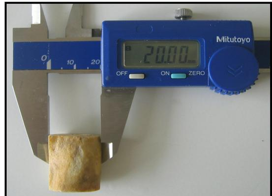
**Figura 6: Aferição da altura da amostra (20mm).**
