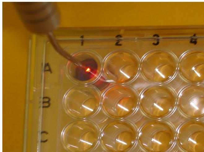
Figura 14: Aplicação da PDT, com posicionamento da fibra óptica no centro do poço
