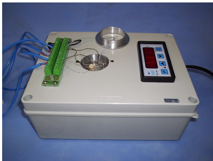
Figura 2. Caixa termoplástica, demonstrando o controlador de temperatura (à direita) e a plataforma para fixação do dente (ao centro).
