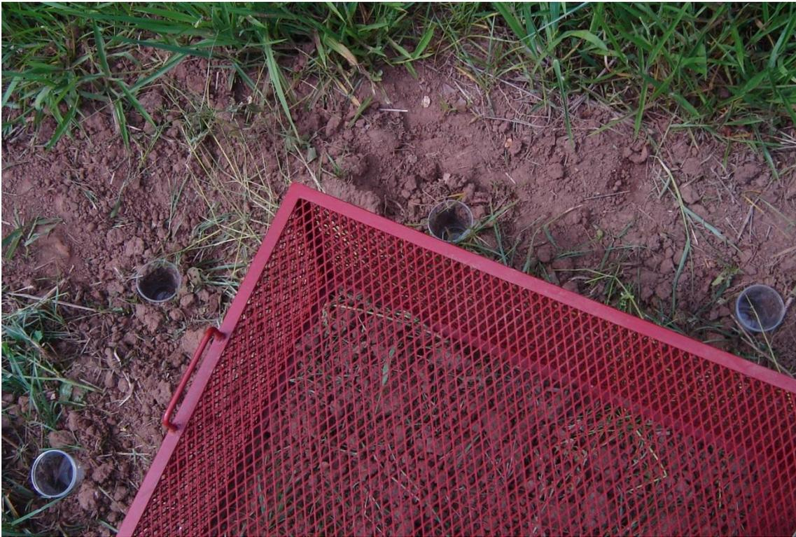
Fig. 1: Detalhe da caixa com malha metálica de  $1,5\text{cm}^2$  e disposição das armadilhas *pitfall* ao redor da caixa.
