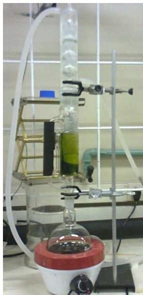
Figura 4.2. Extração em aparelho de Soxhlet.
