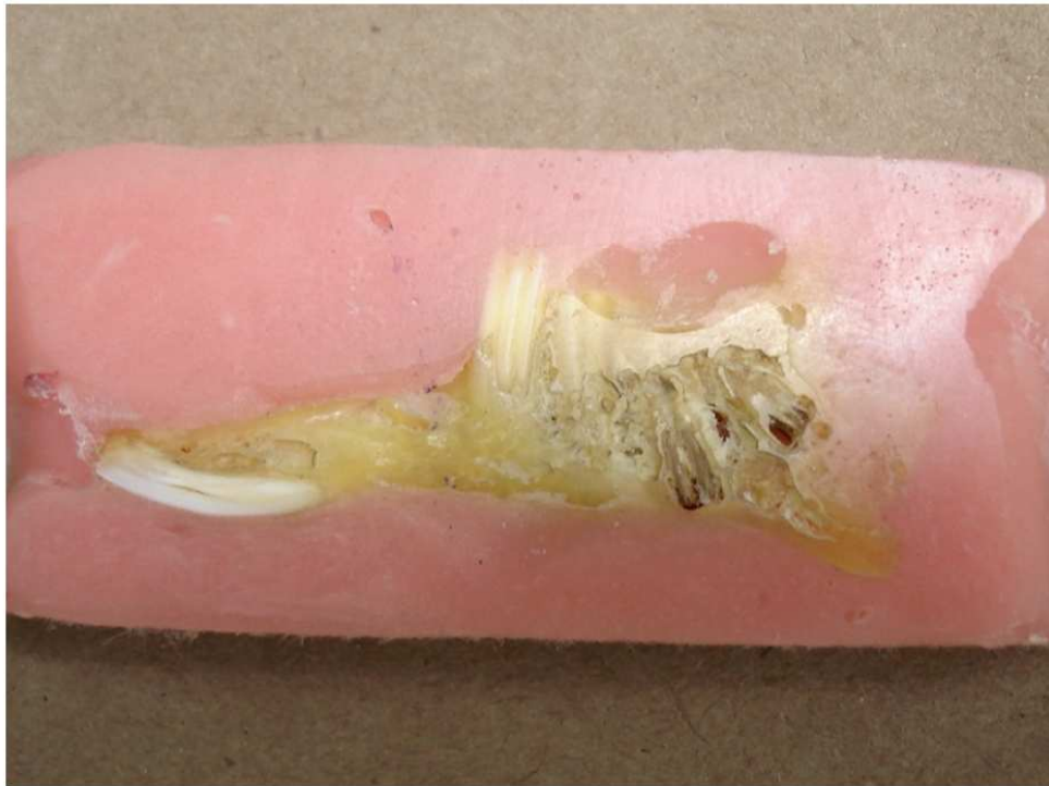
Figura 13. Amostra incluída em resina acrílica após lixamento e polimento.
