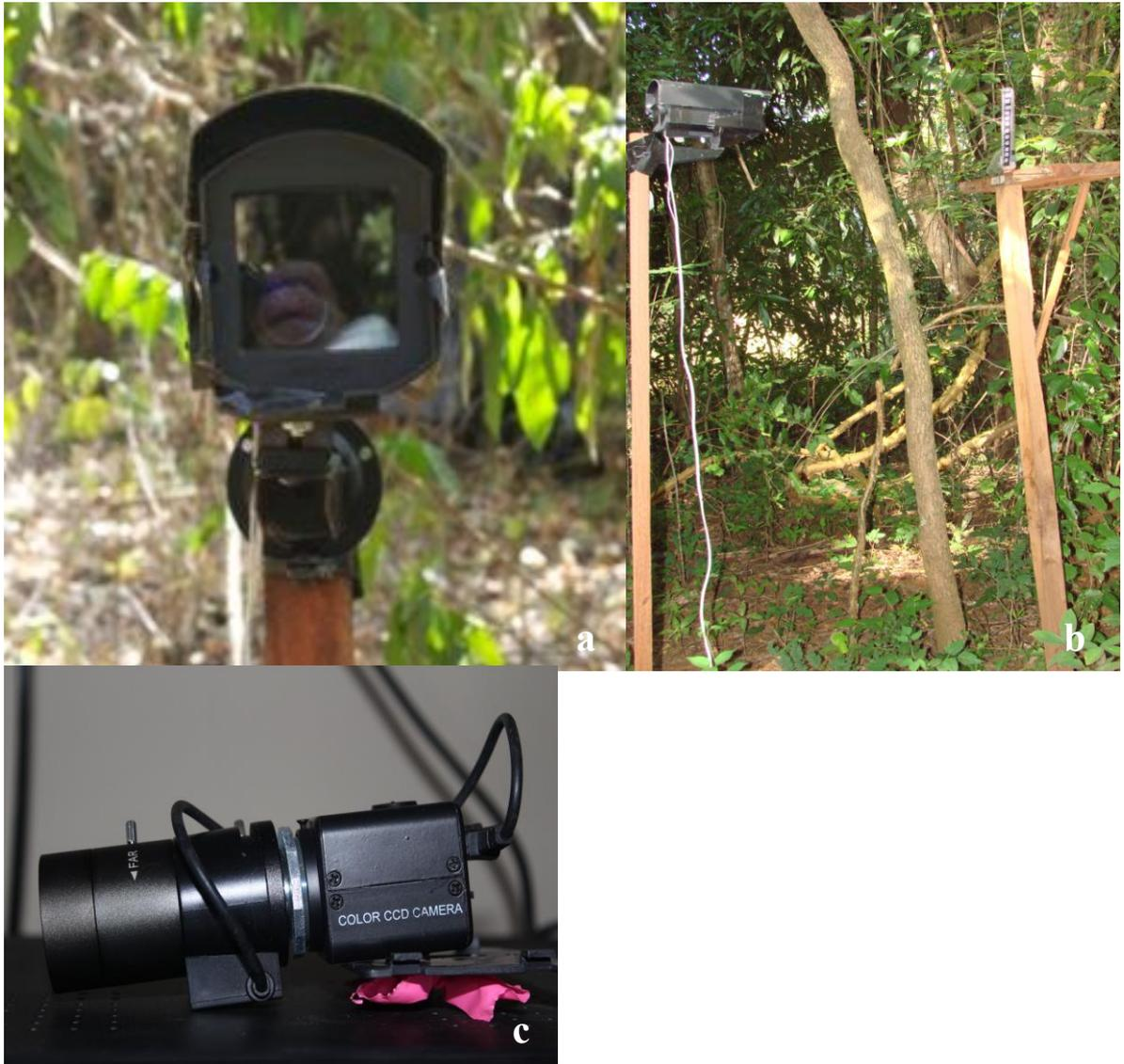
**Figura 8.** (a) Caixa de proteção, (b) caixa de proteção fixada à estaca de madeira e à plataforma de alimentação e (c) câmera profissional com lente 6-60 mm utilizada para filmar as visitas dos grupos de estudo nas plataformas de alimentação.
