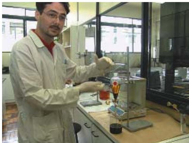
Laboratório: 20% de *biodiesel* é misturado ao *diesel* comum
