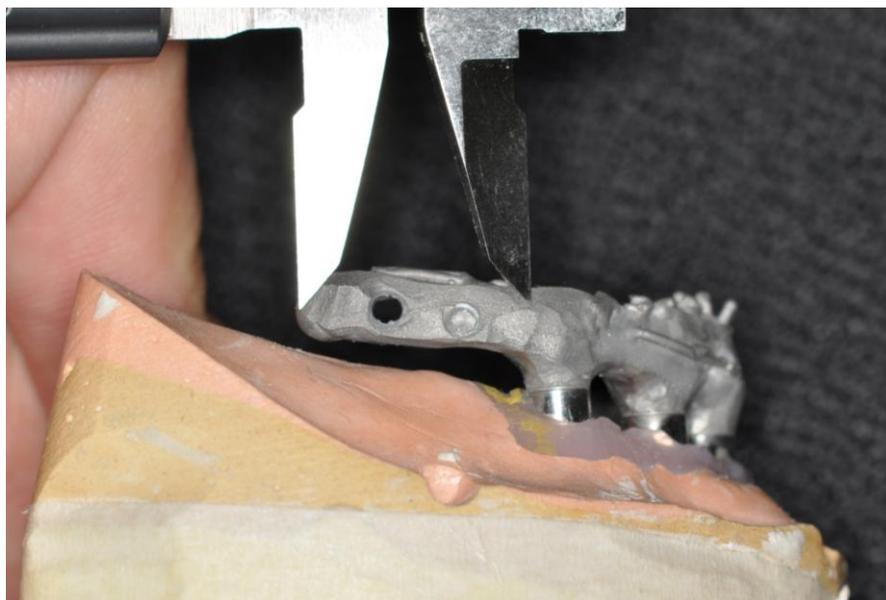
**FIGURA 2:** Medição da extensão do cantilever distal com paquímetro digital
