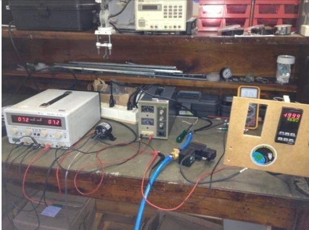
Figura 78: Teste da válvula com fonte de tensão externa controlável
