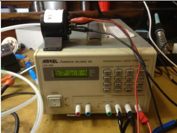
Figura 84: Utilização de fonte simétrica para transdutor
