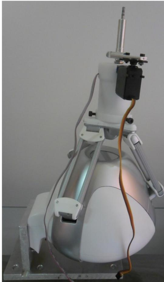
**Figura 28 - Protótipo para simulação de movimentos cinemáticos endodônticos**
