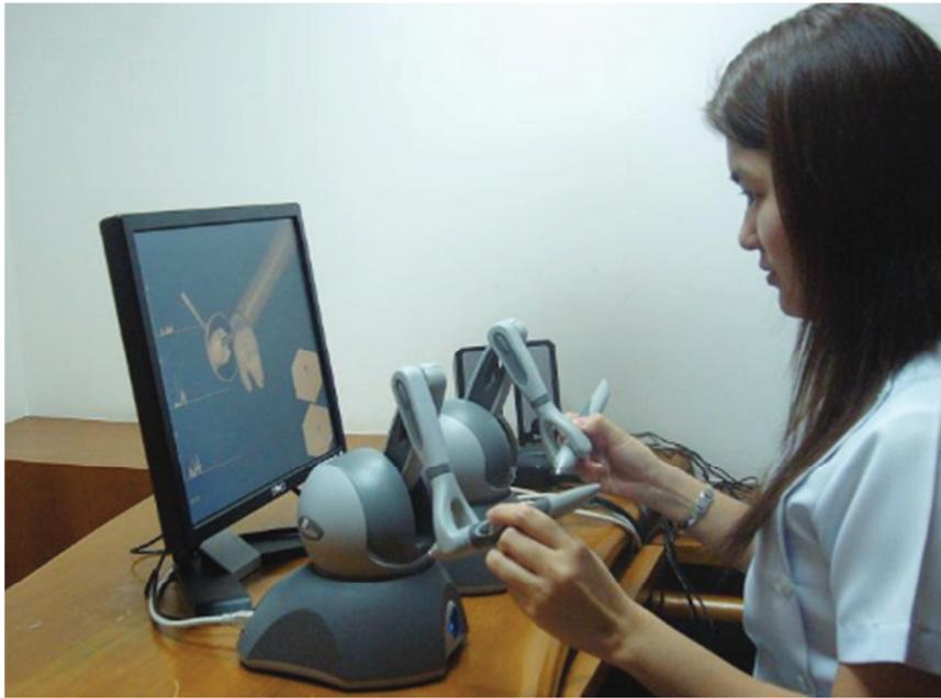
Figura 24 - Utilização do simulador com dois dispositivos hápticos
