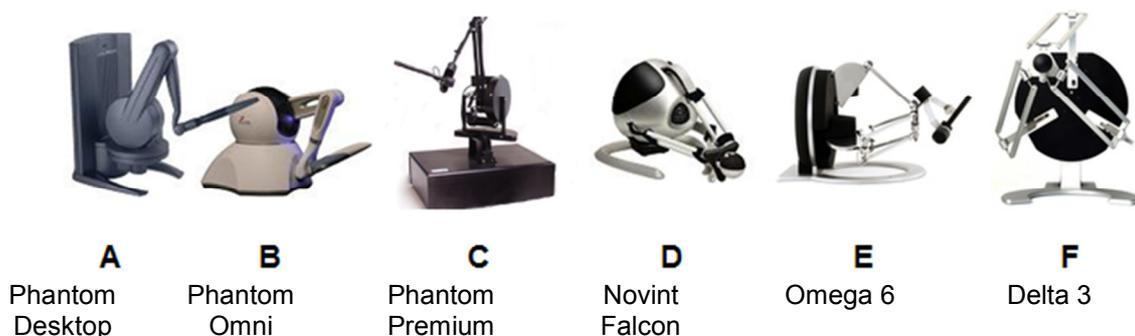
**Figura 16 - Dispositivos hápticos comerciais**
