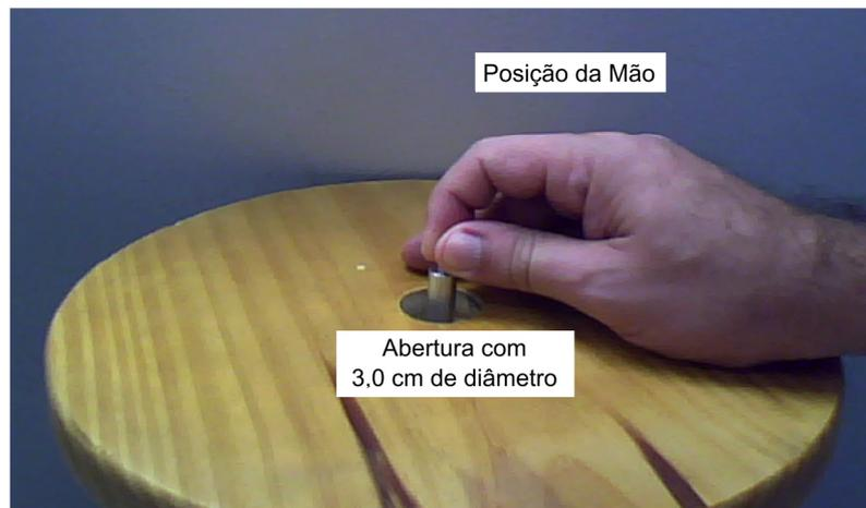
**Figura 34 - Suporte para a mão do usuário com a abertura limitadora de movimentos**
