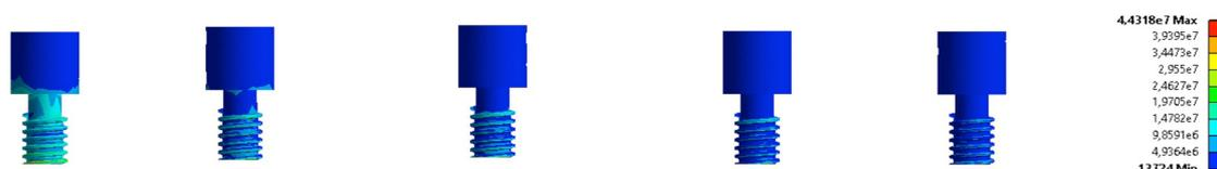
**Figura 23.** Incidência de tensões nos parafusos protéticos do modelo 5R.
