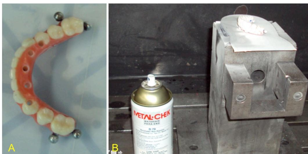
**Figura 6.** A – Posicionamento das quatro esferas de referência; B – Aplicação do revelador não aquoso.
