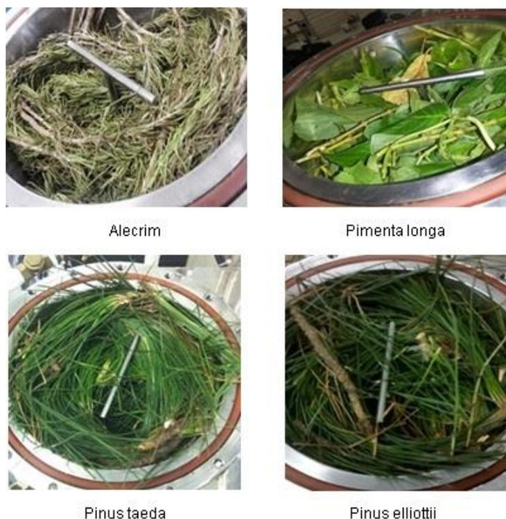
Figura 4.4: Vaso de extração com as partes aéreas das plantas aromáticas.
