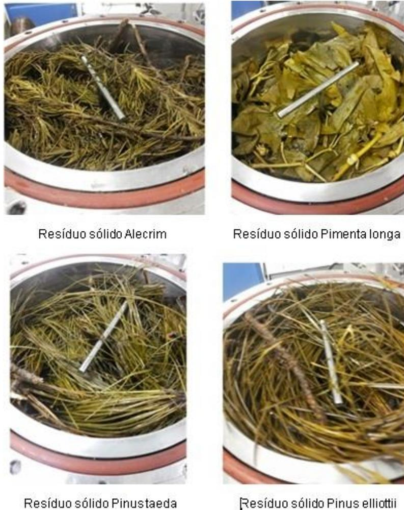
Figura 5.1: Resíduos sólidos gerados no processo de extração por arraste a vapor
