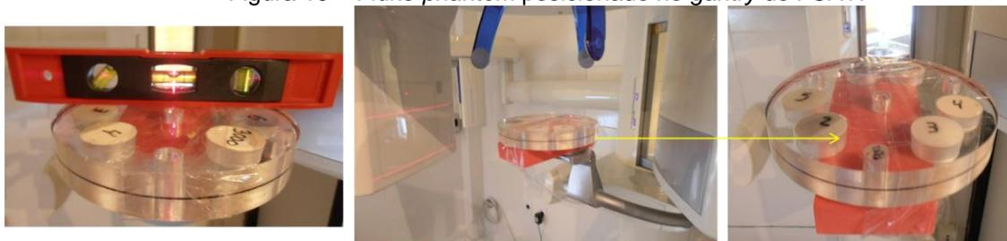
(a) Verificação do alinhamento e nivelamento do phantom, (b) *gantry* do equipamento Orthophos XG 3D e (c) *phantom* posicionado para a aquisição das imagens.
