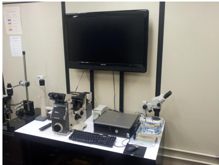
Figura 4.5. Microscópio óptico da marca Olympus utilizado neste estudo.
