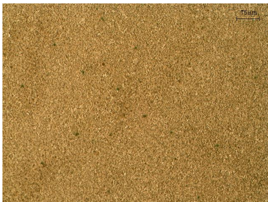
Figura 5.3. Análise micrográfica aço SAE 1045 temperado e revenido a 300°C apresentando estrutura martensítica. Ataque Químico: Nital: a) Aumento de 100x; b) Aumento de 500x.
