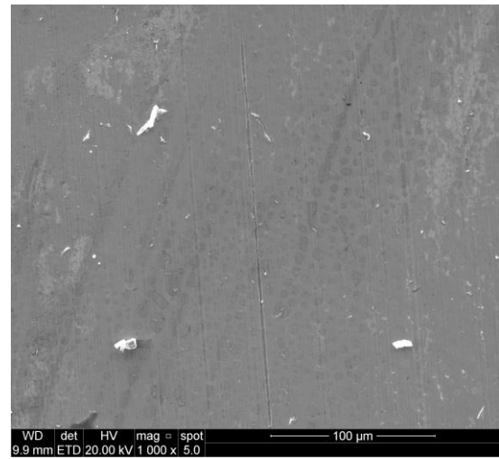
Figura B – Amostra 10A lubrificado com B7, apresentando microcorte – aumento de 1000x
