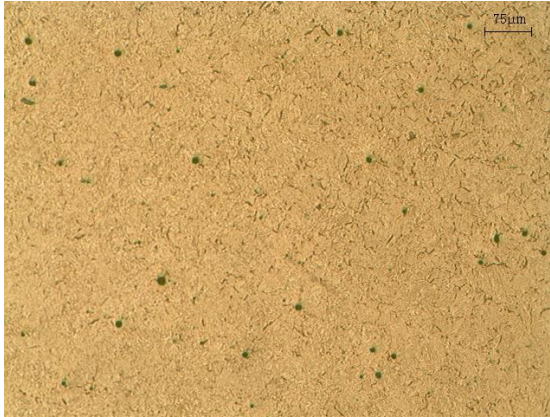
Figura 5.2. Análise micrográfica aço SAE 1045 temperado e revenido a 100°C, apresentando estrutura martensítica. Ataque Químico: Nital: a) Aumento de 100x; b) Aumento de 500x.
