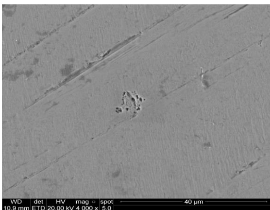
Figura C - Amostra 52B, sem lubrificação, apresentando escorreamento – aumento de 4000x
