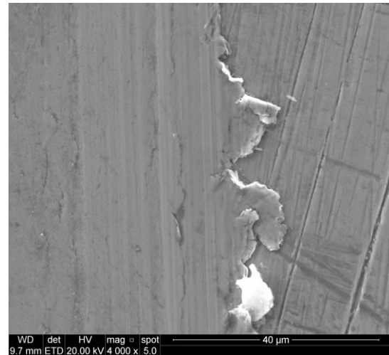
Figura D – SAE 1045 temperado e revenido a 300°C lubrificado com B7, apresentando escorreamento – aumento: 4000x
