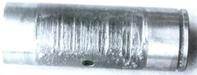
Figura 3.2. Escorreamento gerado por desgaste adesivo
